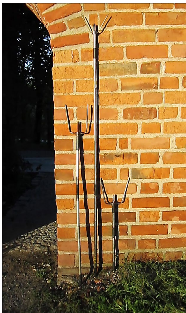
Ryc. 3. Różne długości lancy iniekcyjnej zestawiane w trakcie pracy
