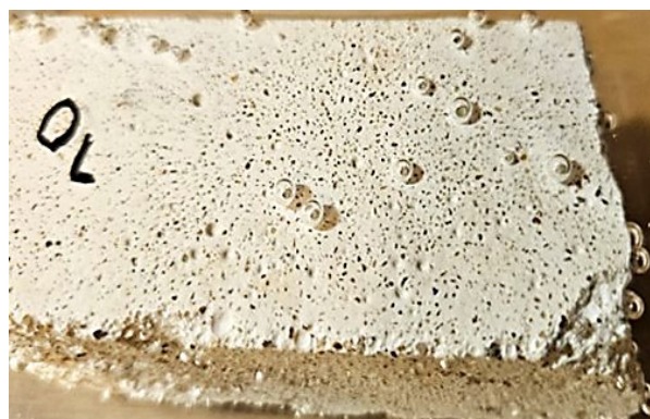
Ryc. 5. Próbką ML podczas badania mrozoodporności – widoczne pęcherzyki powietrza podczas zalewania wodą; fot. D. Logoń
