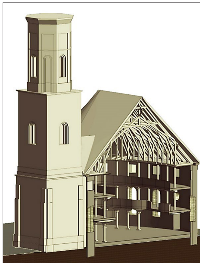
Ryc. 3. Model HBIM kościoła w Żeliszowie; źródło: Bednarz 2023 Fig. 3. HBIM model of the church in Żeliszów; source: Bednarz 2023
