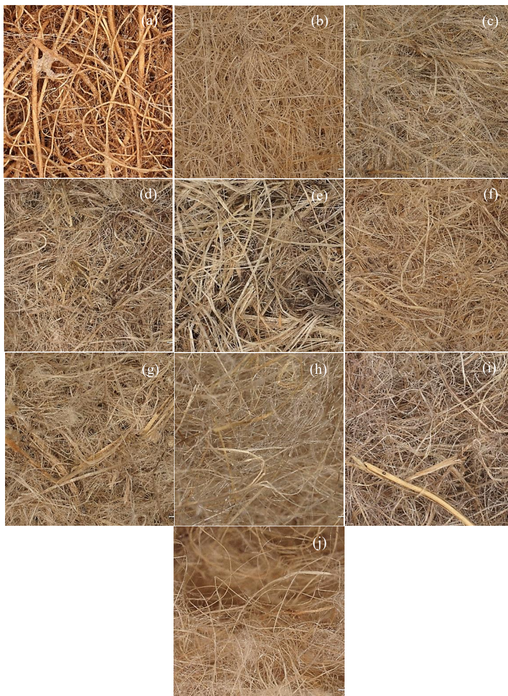
Rysunek 19. Makrofotografie włókien w postaci mat, filców i wełny: a) mata kokosowa, b) filc jutowy, c) filc lniany, d) filc lniano-konopny 1, e) filc konopny, f) filc lniano-jutowy, g) filc lniano-konopny 2, h) wełna lniana, i) wełna konopna, j) wełna lniano-jutowa.
