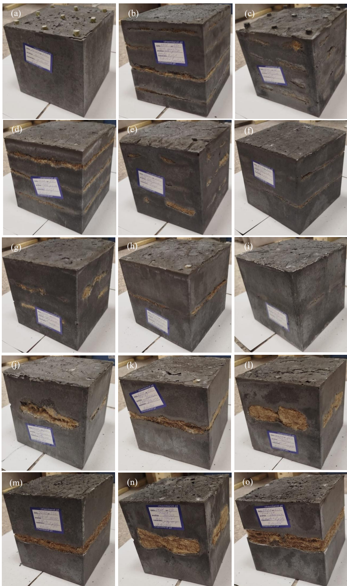
Rysunek 28. Makrofotografie warstwowych kompozytów geopolimerowych: a) RKG, b) K4M-8P-R, c) K4MP-8P-R, d) K3M-6P-R, e) K3MP-6P-R, f) K2M-4P-R, g) K2MP-4P-R, h) K1M-2P-R, i) K1MP-2P-R, j) K2MP-2P-Ś, k) K2M-2P-Ś, l) K3MP-2P-Ś, m) K3M-2P-Ś, n) K4MP-2P-Ś, o) K4M-2P-Ś.
