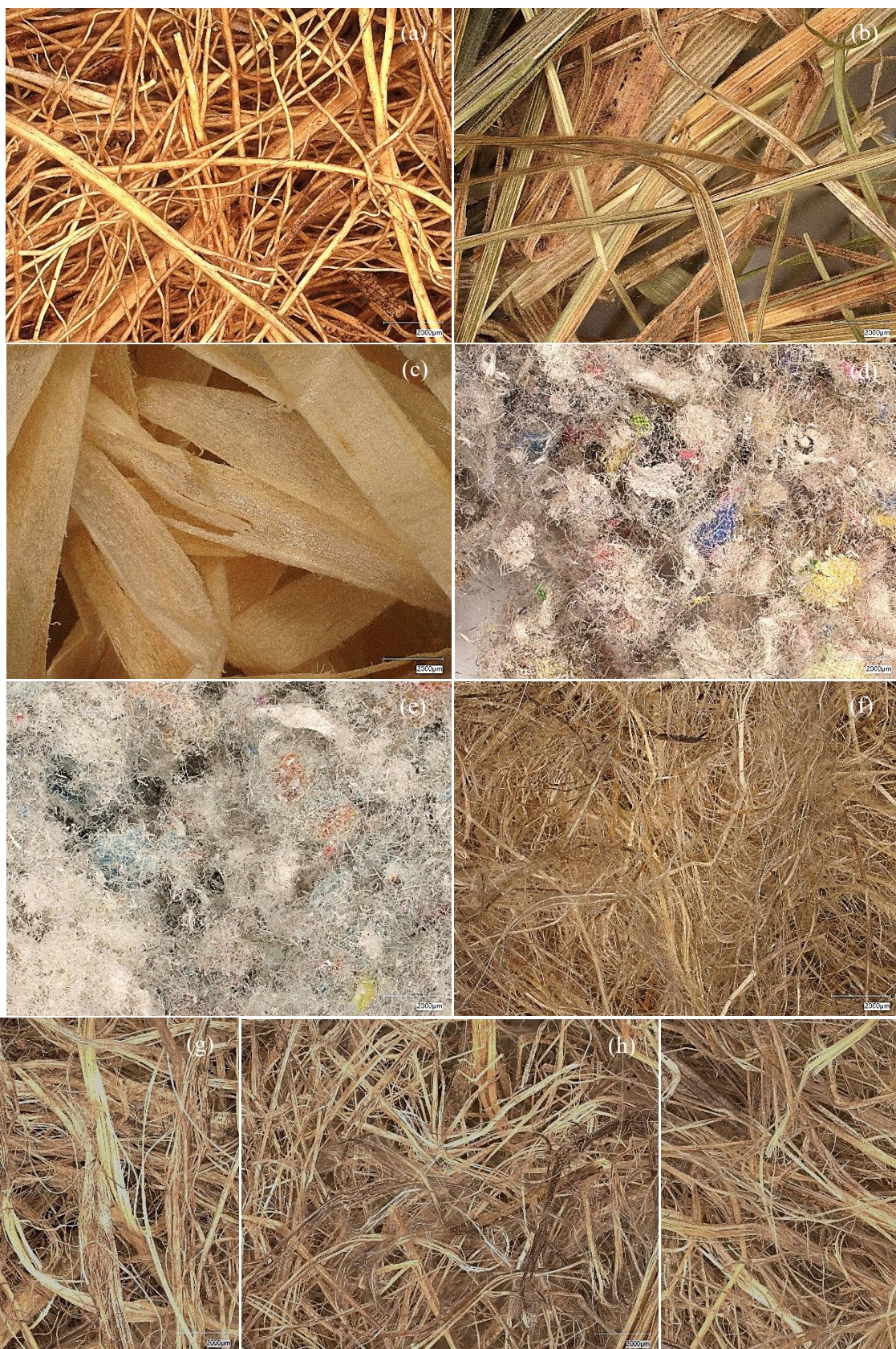
Rysunek 18. Obrazy makroskopowe włókien ilustrujące różne typy materiałów: a) włókna kokosowe, b) siano, c) wióry drzewne, d) celuloza PRO AGRO, e) celuloza VestaEco CELL, f) włókna lniano-konopne, g) włókna konopne 1, h) włókna konopne 2, i) włókna konopne 3.
