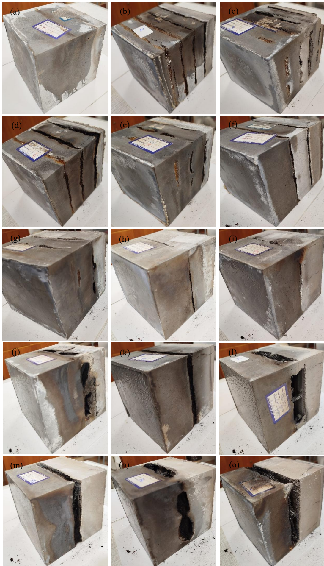
Rysunek 39. Makrofotografie kompozytów po działaniu wysokich temperatur: a) RKG, b) K4M-8P-R, c) K4MP-8P-R, d) K3M-6P-R, e) K3MP-6P-R, f) K2M-4P-R, g) K2MP-4P-R, h) K1M-2P-R, i) K1MP-2P-R, j) K2MP-2P-Ś, k) K2M-2P-Ś, l) K3MP-2P-Ś, m) K3M-2P-Ś, n) K4MP-2P-Ś, o) K4M-2P-Ś.
