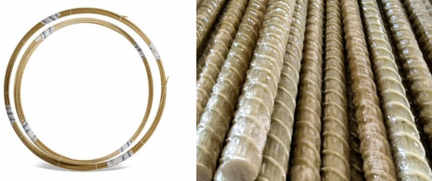
Rysunek 21. Pręty kompozytowe z włókna szklanego przesyconego żywicą epoksydową zastosowane jako zbrojenie w kompozytach warstwowych [176].
