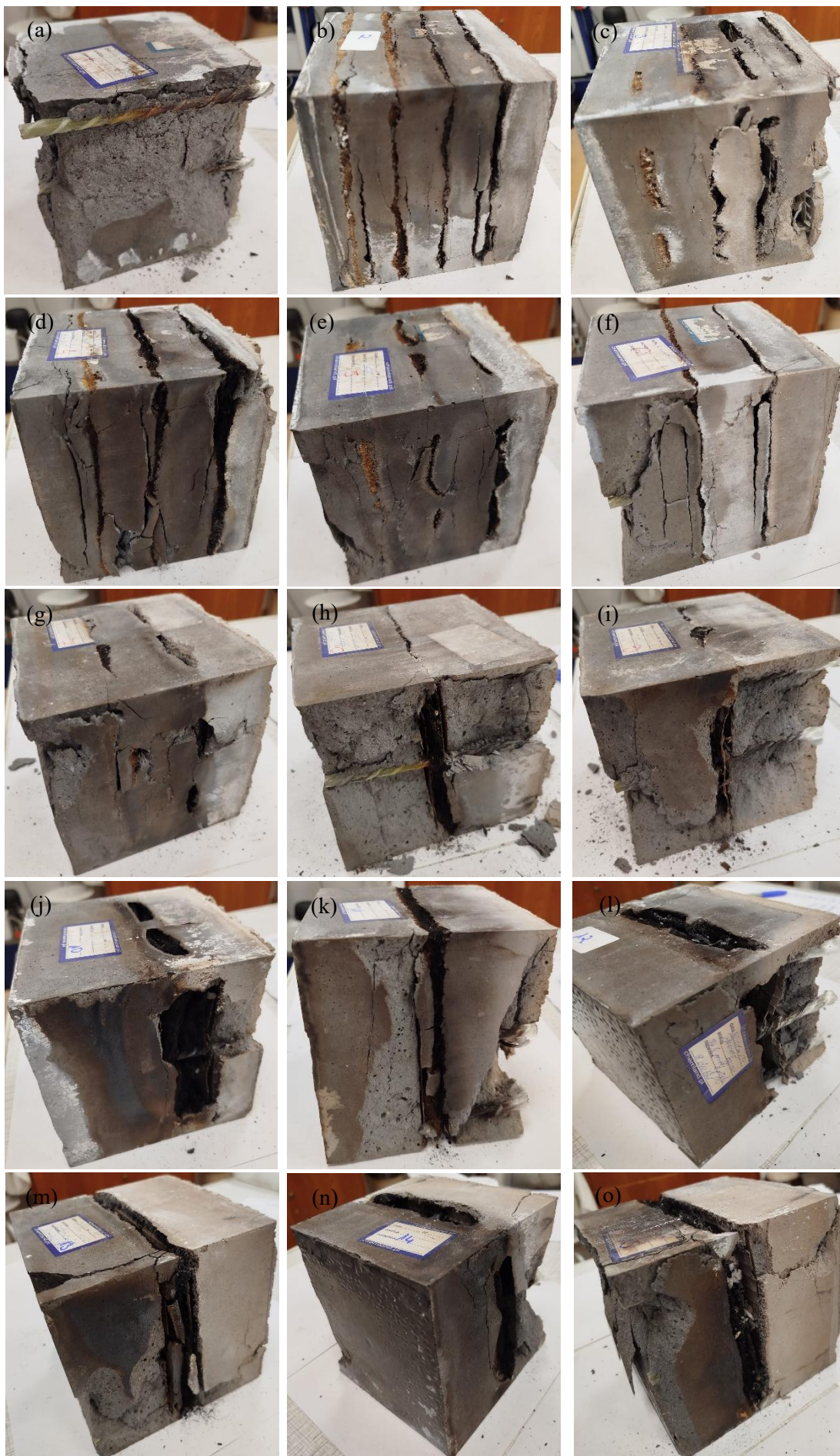
Rysunek 41. Makrofotografie kompozytów po działaniu temperatury i ściskaniu: a) RKG, b) K4M-8P-R, c) K4MP-8P-R, d) K3M-6P-R, e) K3MP-6P-R, f) K2M-4P-R, g) K2MP-4P-R, h) K1M-2P-R, i) K1MP-2P-R, j) K2MP-2P-Ś, k) K2M-2P-Ś, l) K3MP-2P-Ś, m) K3M-2P-Ś, n) K4MP-2P-Ś, o) K4M-2P-Ś.
