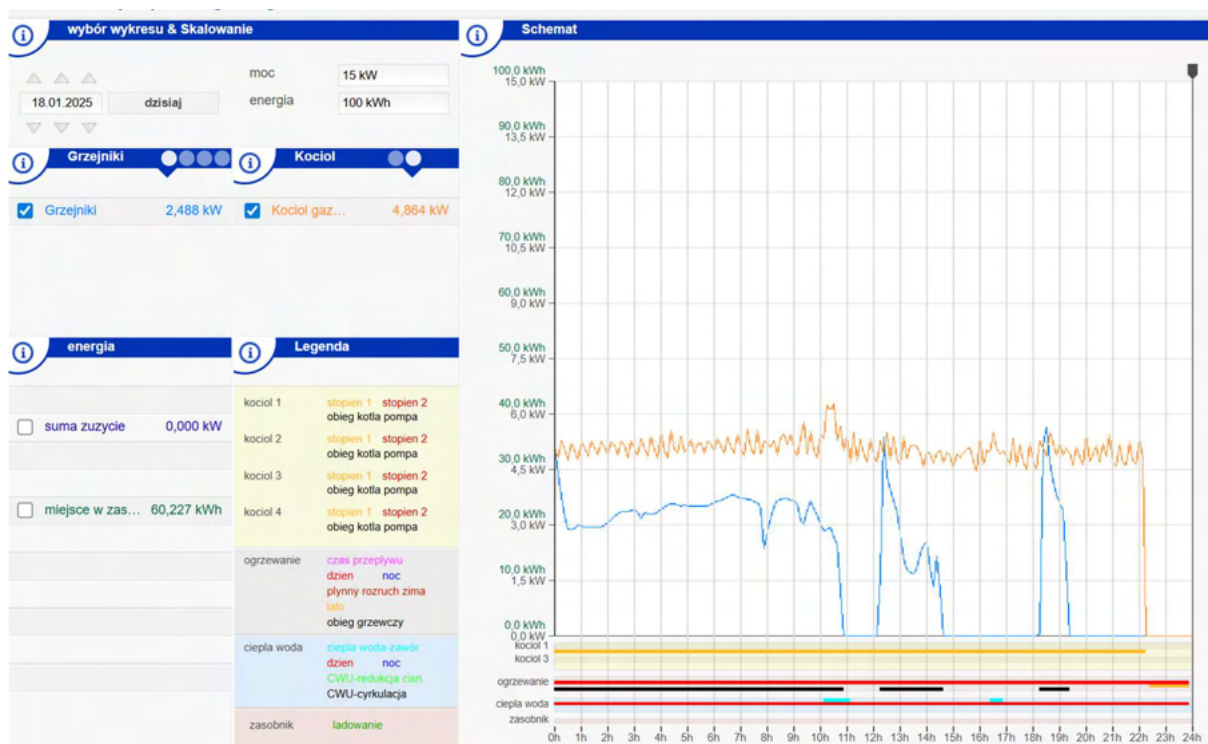
Rys. 11. Dobowy wykres mocy grzewczej kotła oraz mocy grzejników w części mieszkalnej, wygenerowany w programie DigiENERGY – dane z 18.01.2025
