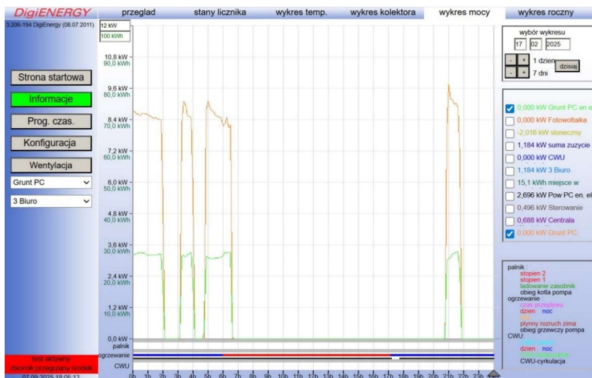
Rys. 72. Wykres mocy gruntuw pompy ciepła w dniu 17.02.2025
