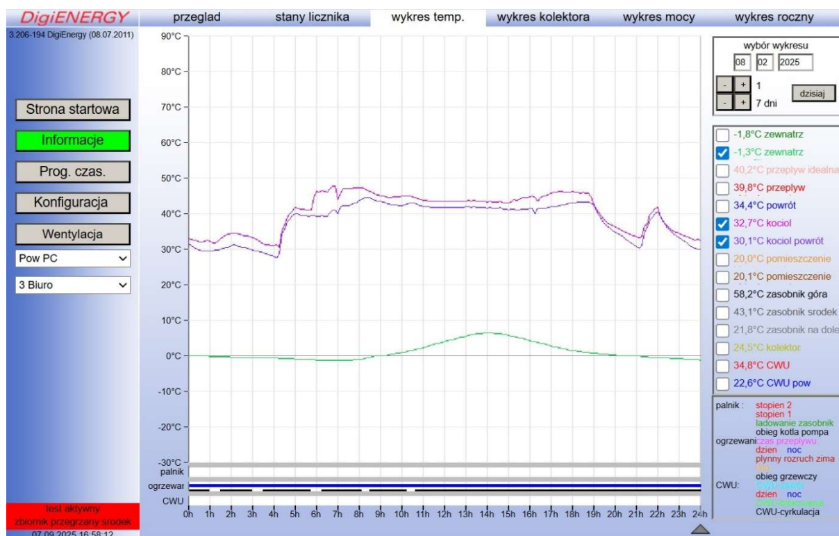
Rys. 68. Wykres przebiegu temperatur zasilania i powrotu powietrznej pompy ciepła w dniu 08.02.2025
