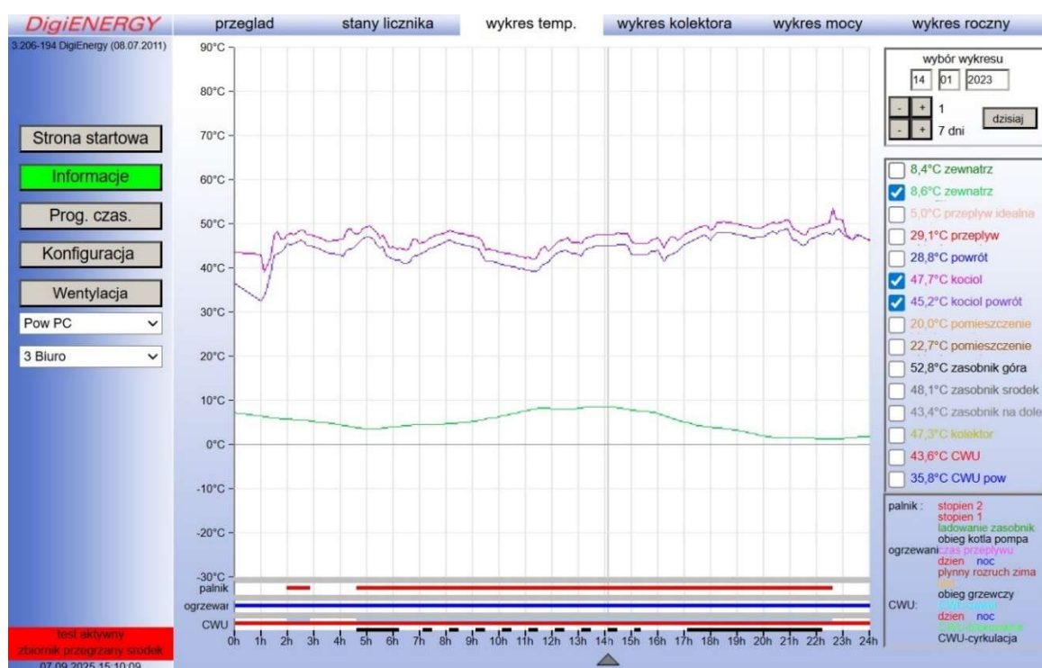
Rys. 28. Wykres przebiegu temperatur zasilania i powrotu powietrznej pompy ciepła w dniu 14.01.2023
