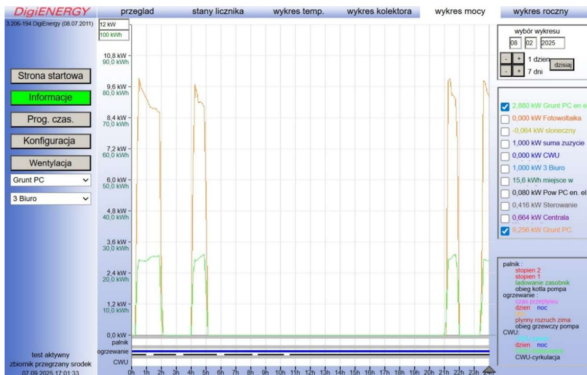
Rys. 65. Wykres mocy gruntowej pompy ciepła w dniu 08.02.2025
