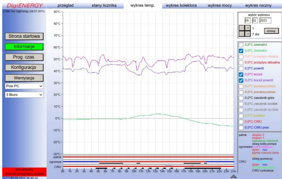
Rys. 39. Wykres przebiegu temperatur zasilania i powrotu powietrznej pompy ciepła w dniu 08.02.2023
