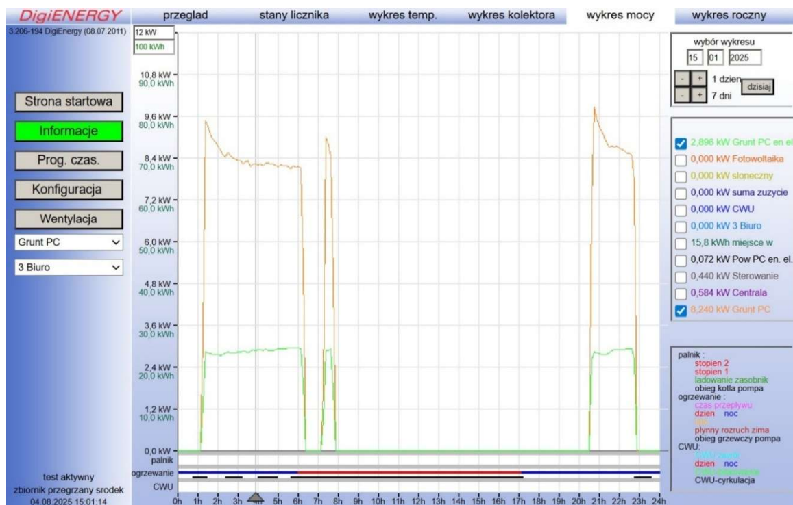
Rys. 62. Wykres mocy gruntowej pompy ciepła w dniu 15.01.2025
