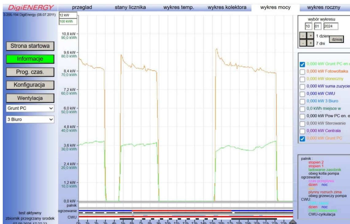
Rys. 43. Wykres mocy gruntowej pompy ciepła w dniu 10.01.2024
