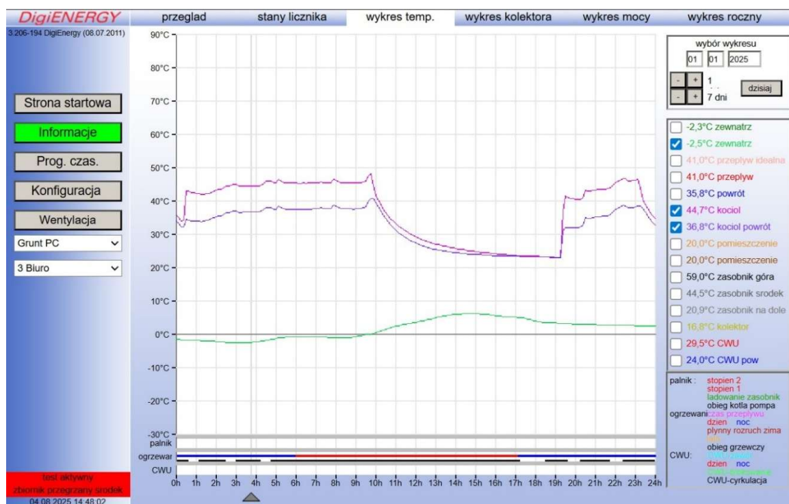
Rys. 57. Wykres przebiegu temperatur zasilania i powrotu gruntowej pompy ciepła w dniu 01.01.2025
