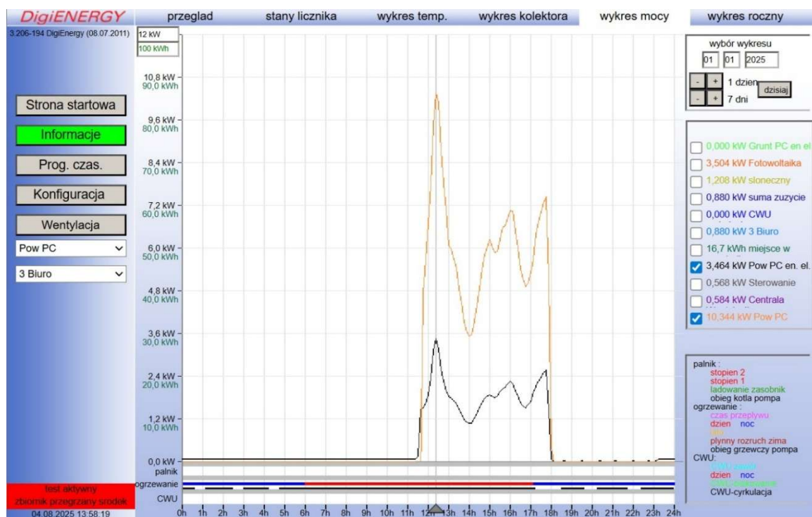
Rys. 56. Wykres mocy powietrznej pompy ciepła w dniu 01.01.2025
