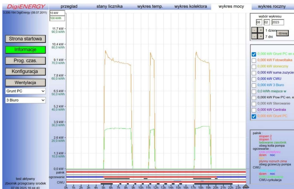
Rys. 37. Wykres mocy gruntowej pompy ciepła w dniu 08.02.2023
