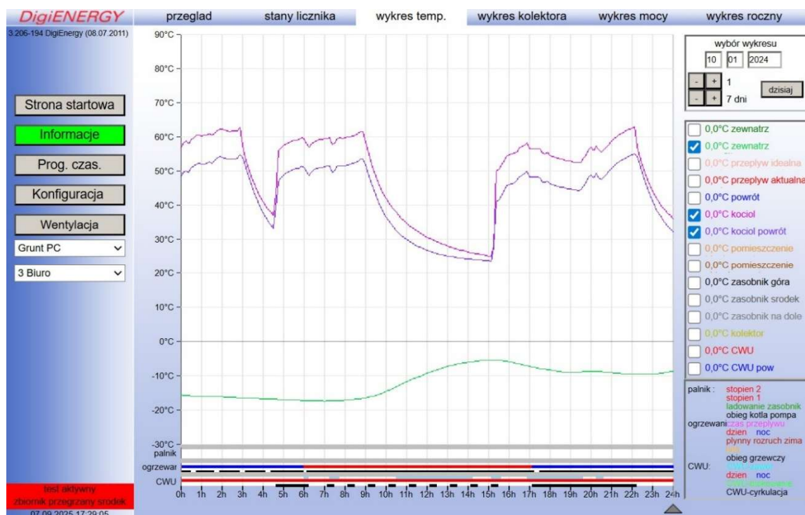
Rys. 41. Wykres przebiegu temperatur zasilania i powrotu gruntowej pompy ciepła w dniu 10.01.2024
