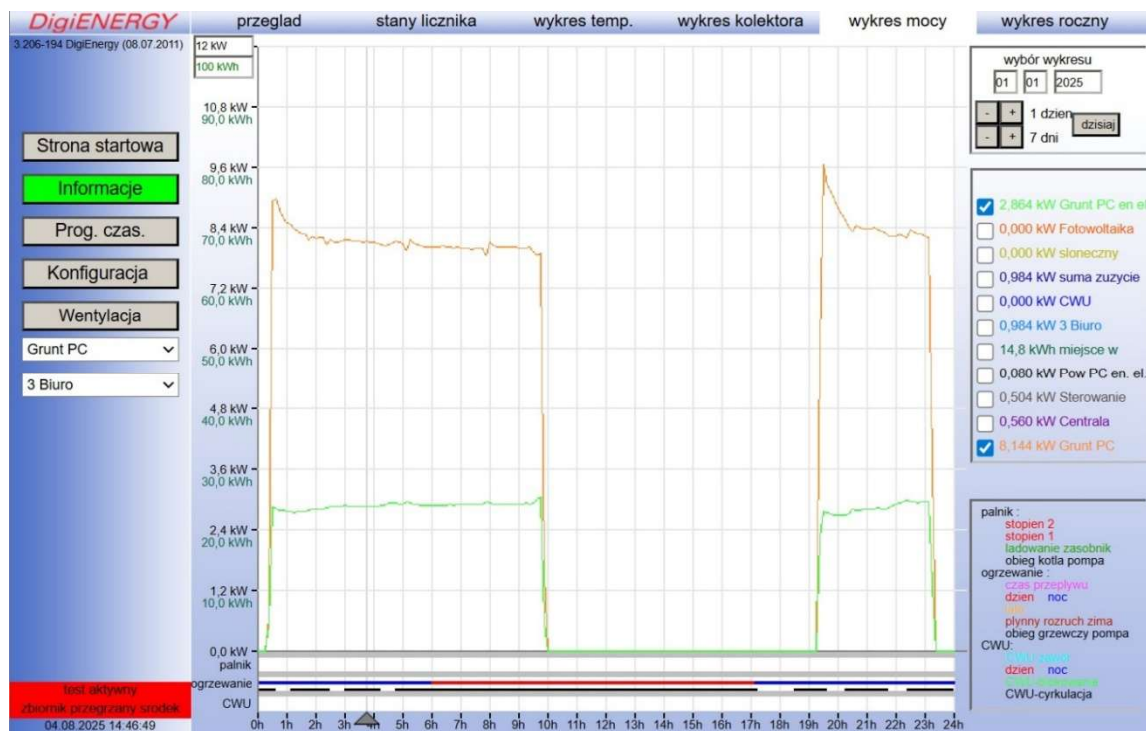
Rys. 55. Wykres mocy grzewczej pompy ciepła w dniu 01.01.2025
