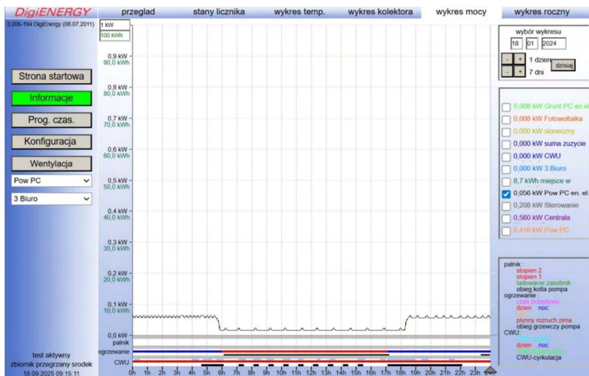
Rys. 46. Wykres mocy powietrznej pompy ciepła w dniu 18.01.2024
