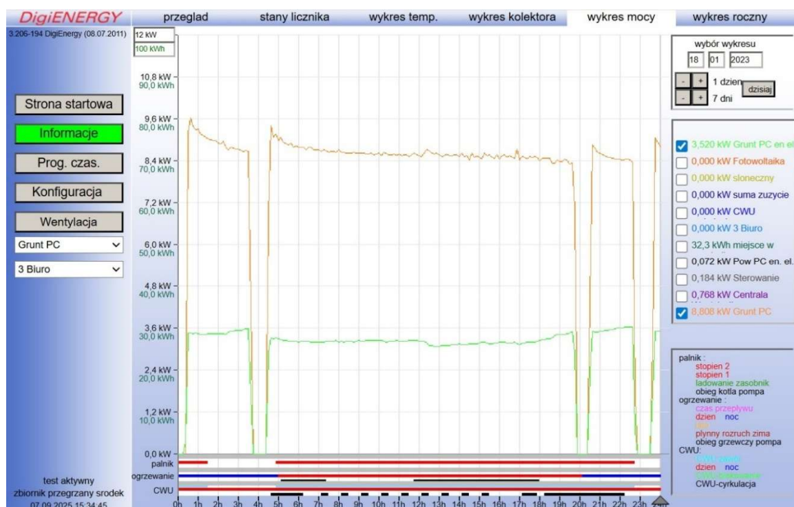
Rys. 30. Wykres mocy grzewczej pompy ciepła w dniu 18.01.2023
