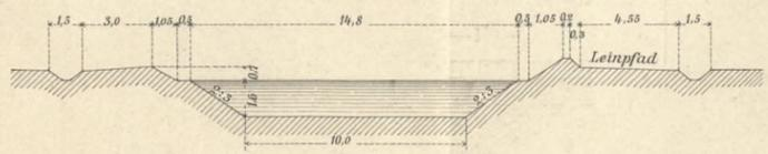
Fig. 7. Anschluss der Röhrenleitung an das offene Gerinne. 1:200.
