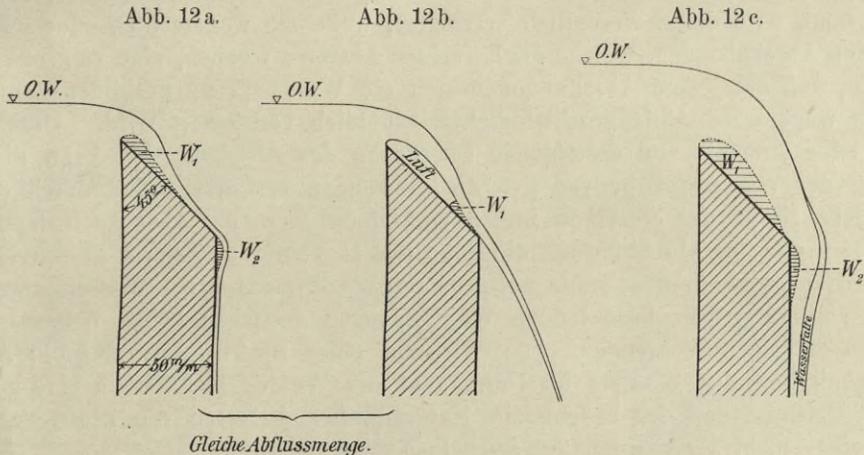
Abb. 12. Ausbildung angeschmiegener Strahlen bei abgeschrägten Wehren.
