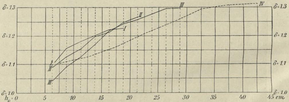
Abb. 11. Zusammenstellung der Werte  $\delta$  für Überfälle mit angeschmiegtm Strahl nach Bazin.
