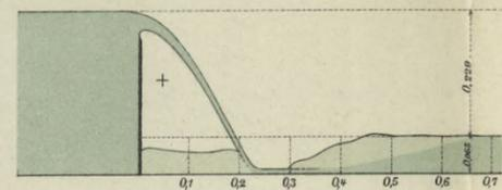
Abb. 7. Angeschmiegtter Strahl mit wassergefülltem Kopf und verdecktem Fuhs.
