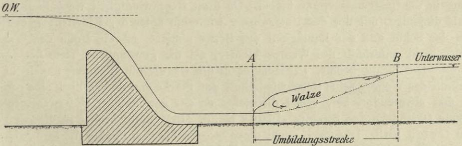
Abb. 1. Querschnitt durch ein Schußwehr.
