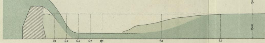
Abb. 21. Wassergefüllter Strahl mit freiem Fuhs.
