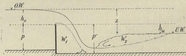
Abb. 7. Querschnitt durch einen wassergefüllten Strahl mit freiem Fuß.
