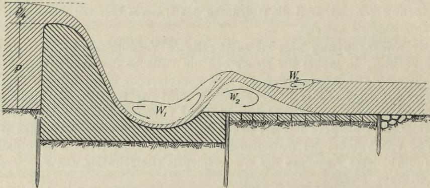
Abb. 3. Querschnitt durch ein Schußwehr mit vertieftem Sturzbecken.
