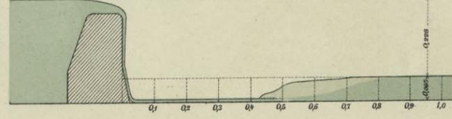
Abb. 16. Gelüfteter Strahl mit freiem Fuhs.
