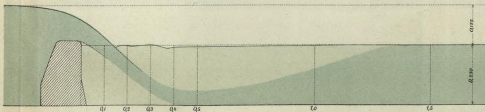
Abb. 18. Gelüfteter Strahl mit freiem Fuhs.
