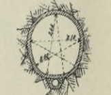
Querschnitt der Druck-Stollens. M: 1:200.
