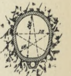
Querschnitt des Druck-Stollens. M: 1:200.
